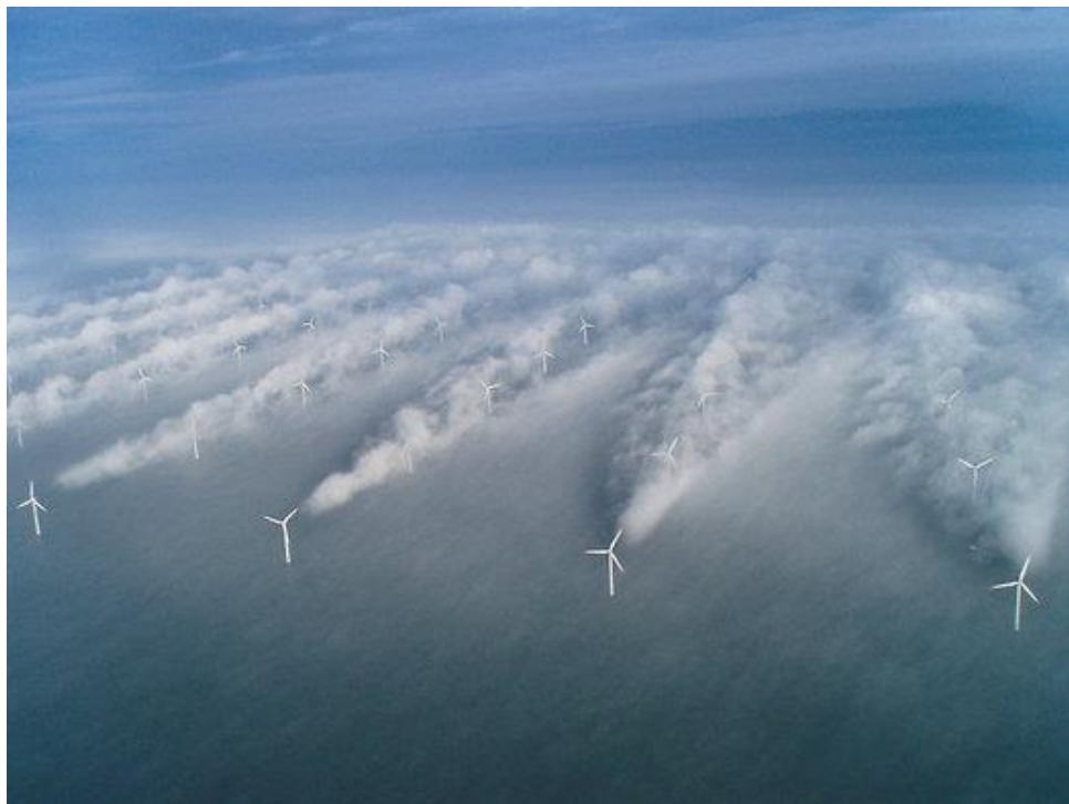
Figure 11 : traînées de la centrale danoise Horns Rev 1, montrant les turbulences derrière les éoliennes. Source : Vatenfall
